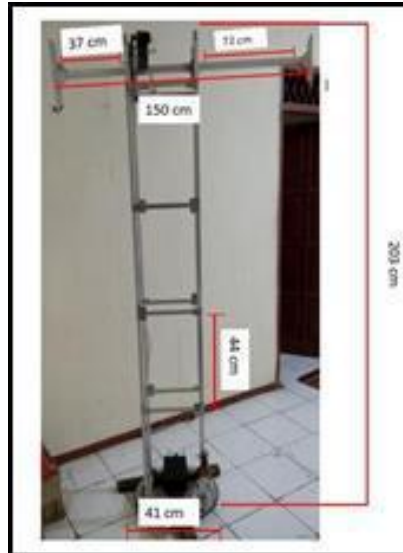
Gambar 4. Desain Menara antena yagi
