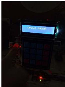
Gambar 7. Pengujian fingerprint upaya masuk
