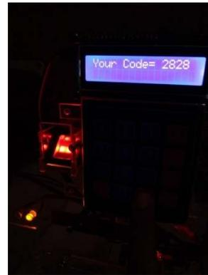
Gambar 9. Pengujian Kode Keypad
