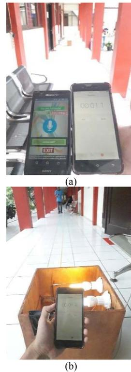
Gambar 6 Pengujian Jarak Konektivitas Pengiriman Bluetooth Tanpa Penghalang (a) Delay Respon Suara (b) Delay Respon Alat
