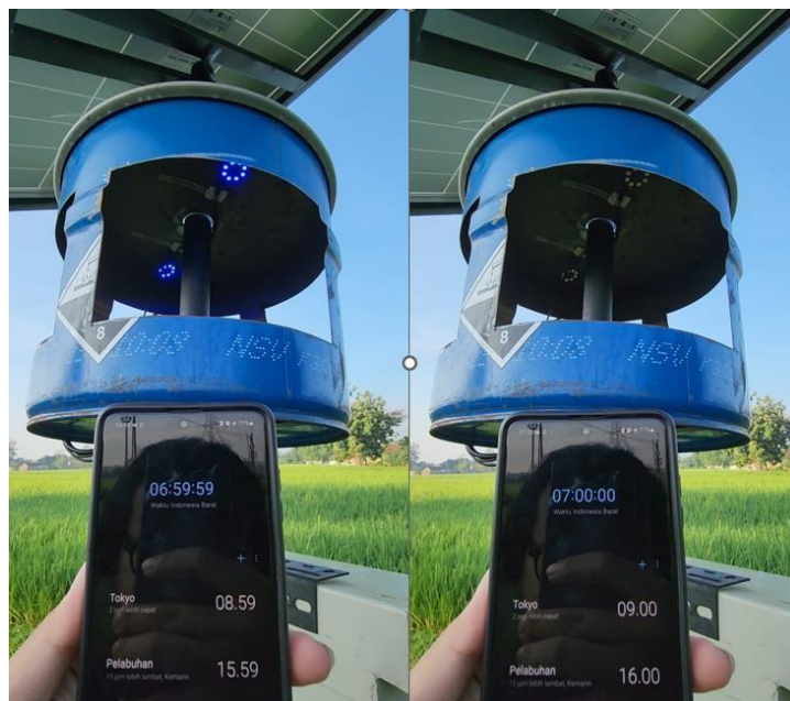
Gambar 4. Pengujian NTP pada pergantian lampu
