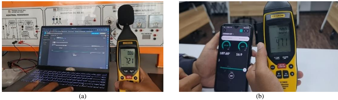
Gambar 7 (a). Hasil pengukuran di dekat PLTB (b). Pengukuran noise di ruang berbeda
